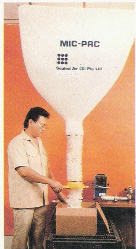
La válvula del anillo giratorio permite un fácil control tanto del fluido como del empaque hacia todas las direcciones. Una sola persona puede volver a llenar las máquinas de distribución debido a que su peso es mínimo.
