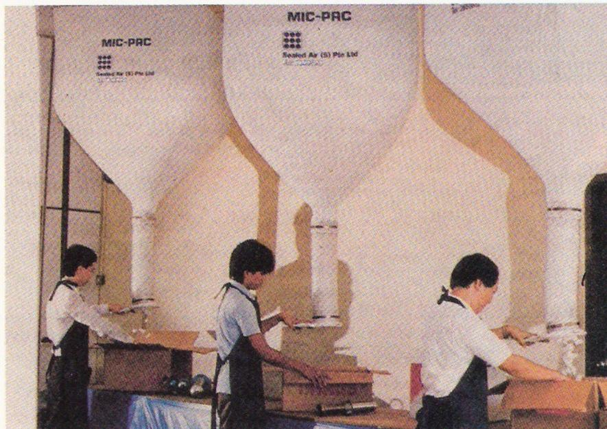
Las bolsas de distribución ocupan un mínimo de espacio en la línea de producción. Cada sistema está equipado con un cable y dos poleas. Debido a que las bolsas son transparentes, el nivel del material siempre es visible.
